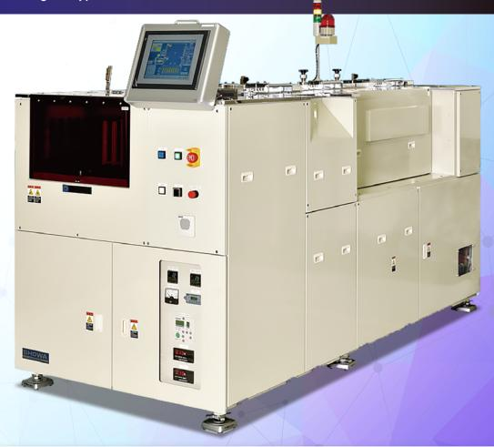
本装置は水晶振動子のベース電極成膜を目的として開発したロードロック式 通過型スパッタリング装置です。仕込・取出室、スパッタ室の2室からなり、加熱 から成膜、取出までを全自動で連動して行うことにより、「ベース電極成膜工程」 のライン化が可能となり生産性の向上と省力化に貢献します。
