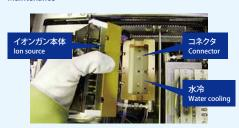
コネクタから引き抜く簡易着脱機構 ▶容易なメンテナンス Pull out from the connector Simple disassembly structure ⇒Maintenance is easy
