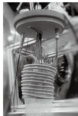
図4 ジュールトムソン効果による極低温液体の過冷却デバイス(熱交換器) 5)
